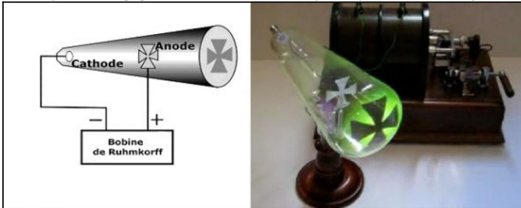
Tube de Crookes (alimenté par une bobine de Ruhmkorff, visible à droite).
